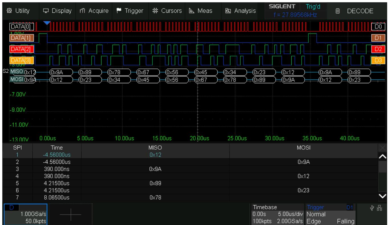
Fig. 168 SDS824X HD\_Digital\_SPI
