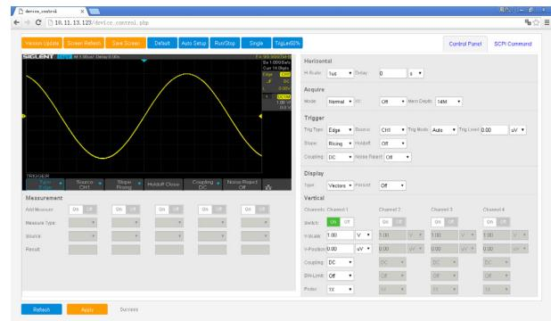
内嵌 Web Server，无需安装驱动软件和上位机软件，通过浏览器即可对仪器进行远程控制、观察波形、获取测量结果，可满足高压、高温等特殊环境的应用需求。
