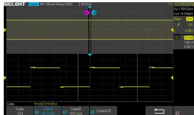
通过 Gate 测量和 Zoom 测量，可以指定任意波形区间进行数据分析统计，聚焦到所关注的区间，避免无效数据带来的测量误差，极大的提升了测量分析的灵活度，满足不同场景下的需求。
