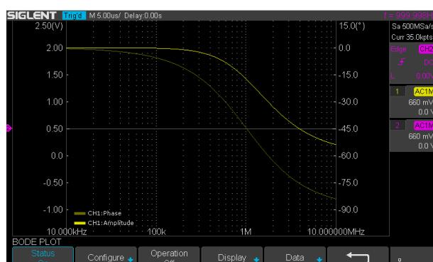
SDS1000X-E 可以控制 USB 任意波形发生器模块或者控制独立的一台 AWG 设备，执行幅频特性和相频特性扫描，把结果以波特图或者列表方式展现出来，并且可以导出扫描数据。
