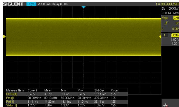
在任一时基下，SDS1000X-E 能对所有的原始采样点完成测量，保证测量精度和采样率的完全同步，可满足高采样率、大存储深度、高精度测量的多重需求。在最大存储深度 14M 的情况下，同样具备极快的运算速度，充分保证了大存储深度下的实时测量和统计功能。
