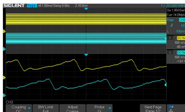
SDS1000X-E 存储深度，通道交织模式为 14Mpts/CH，非交织模式为 7Mpts/CH。在双通道交织模式下，用户能够以 1G 的采样率捕获 14ms 长时间的信号，并结合 Zoom 技术，放大所关注的区域，极大提升了用户可细微捕获的时长。
