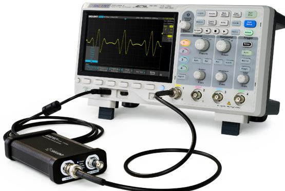
SDS1000X-E 通过 USB Host 接入 25MHz USB 任意波形发生器模块，集成正弦波、方波、三角波、脉冲波、噪声、直流以及 45 种内建任意波，用户也可通过 EasyWave 上位机软件编辑任意波形。
