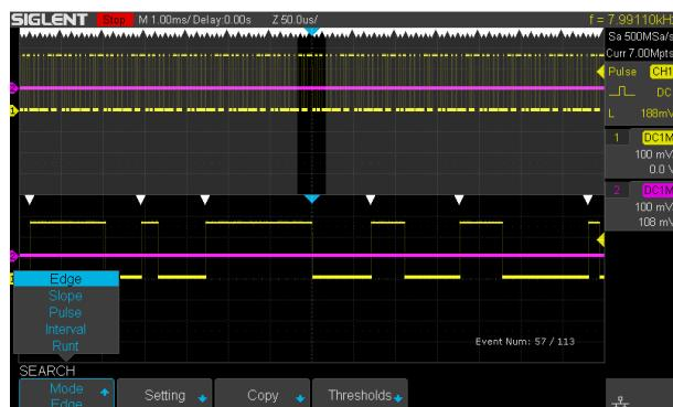
SDS1000X-E 通过指定条件，对一帧波形进行自动搜索，并把搜索结果标识出来，结合导航功能，快速的定位到感兴趣的事件，然后结合示波器的分析功能对事件进行详细的分析，省去了手动搜索的耗时和不便。导航可以对搜索结果按时间和事件导航，也可以对历史帧导航。
