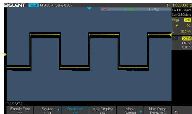
SDS1000X-E 实现了基于硬件的 Pass/Fail 测试功能，每秒执行最高 100,000 次测试。可根据用户自定义的垂直和水平容限，将被测信号与标准规则的同一信号进行比较，适用于长期监测信号或进行生产线测试
