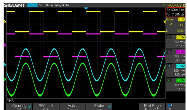
4 通道系列采用 2 片 1Gsa/s ADC 芯片（通道 1、2 共用一片，通道 3、4 共用另一片），4 个通道同时开启时，每个通道采样率依然高达 500MSa/s，保证了 4 个通道能同时工作在 200MHz 带宽。
