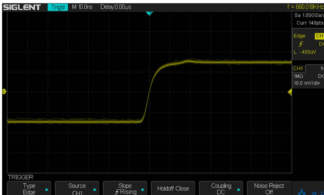
Figure 23 Edge Trigger
